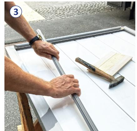
3 Entnehmen Sie die Füllungsleiste und legen Sie sie beiseite.
